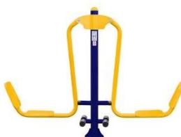
**MATERIAL:** Tubos redondo de aço carbono de no mínimo 3 ½" x 2,00 mm; 2" x 2,00 mm; 2" x 3,00mm. Tubo de aço carbono trefilado SCHEDULE 80 (60,30 mm x 49,22 mm). Chapas de aço carbono de no mínimo 4,75 mm e 2,00 mm.
