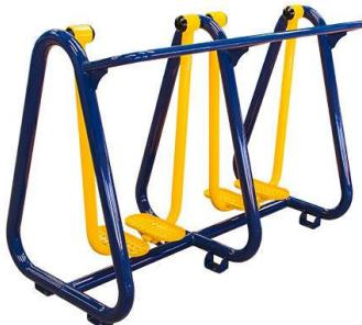
**MATERIAL:** Tubos redondo de aço carbono de no mínimo 2 ½" x 2,00 mm; 2" x 2,00 mm; 1½" x 1,50mm. Tubo de aço carbono trefilado SCHEDULE 80 (73,00 mm x 58,98 mm). Barra mecânica maciça de no mínimo 1 ¼". Chapas de aço carbono de no mínimo 4,75 mm e 1,90 mm.
