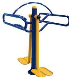
**MATERIAL:** Tubos redondo de aço carbono de no mínimo 3 ½" x 2,00 mm; 2" x 2,00 mm; 1 ½" x 1,50mm e 1" x 1,50 mm. Tubo de aço carbono trefilado SCHEDULE 80 (73,00 mm x 59,98 mm). Barra maciça 1 ¼ ". Chapas de aço carbono de no mínimo 3,75 mm e 1,90 mm.
