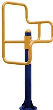
Fabricado com tubos de aço carbono de no mínimo 4' x 3 mm; 3' 1/2 x 3,75 mm; 1' 1/2 x 1,50mm. Chapas de aço carbono com no mínimo 4,75mm. Tampão em plástico injetado de no mínimo no mínimo 3' 1/2 com acabamento esférico. Chumbador com flange de no mínimo 230 mm x 3/16', corte a laser com parafusos de fixação zincados de no mínimo 5/8" x 1 1/4" e arruela zincada de no mínimo 5/8", hastes de ferro maciço trefilado de no mínimo 3/8.
